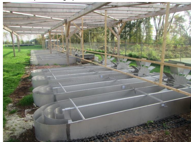
Abb.1: Rezirkulierende Fließgewässermesokosmosanlagen mit Schaufelradantrieb und optionalem Sonnenschutz
